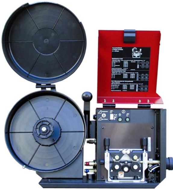
Bild 13 Blick in ein Drahtvorschubgerät mit 4-Rollenantrieb
