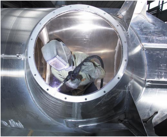
Bild 42 MIG-Schweißen beim Herstellen von Aufliedertanks
