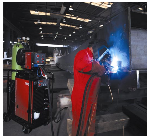
Bild 38 MAG-Schweißen an Trägern im Stahlbau
